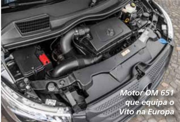
O engenheiro de Produto Vans da Mercedes-Benz, Luiz Gonzaga, conta um pouco como funciona o sistema no motor OM 651 LA com biturbo, que equipa as vans Sprinter. Ele explica que o ar entra no motor pela turbina e mistura com o combustível para que aconteça a combustão, quando sai do motor, ao invés de sair direto pelo escapamento, ele faz uma recirculação, já quente dentro do motor, e já sai com particulados devido à combustão.
