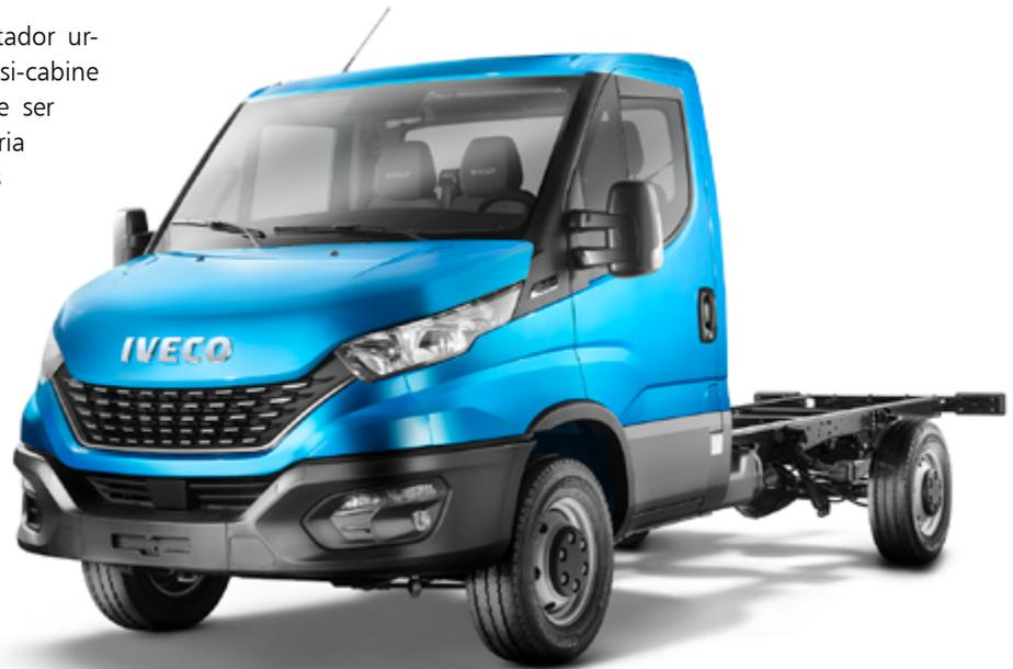
Sobre o chassi, um aumento do entre-eixos e do comprimento total, as mudanças estruturais na versão furgão permitiram novas configurações de metragem cúbica que agora vão de 7,3 a 18 m<sup>3</sup>. Na versão chassi-cabine longarinas em perfil "C" de 5mm e o robusto conjunto suspensivo são destaques do já conhecido do modelo. ▀
